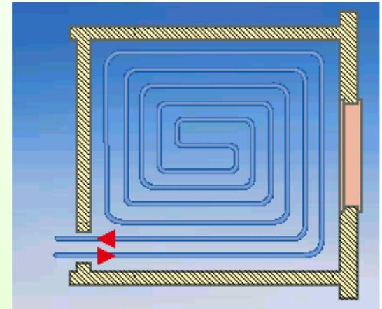
Raccorder le début extérieur de la couronne sur le départ du circuit à mettre en oeuvre.
